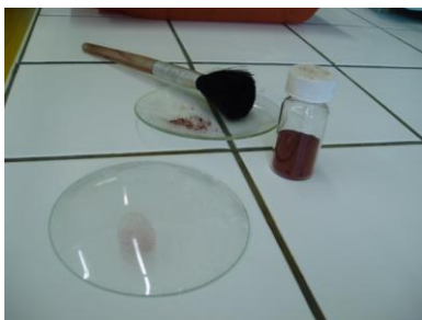
Obr. 10 Zviditelnění daktyloskopické stopy jemně mletým oxidem železitým
