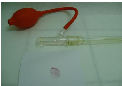
Obr. 11 Zviditelnění daktyloskopické stopy reakcí s ninhydrinem
