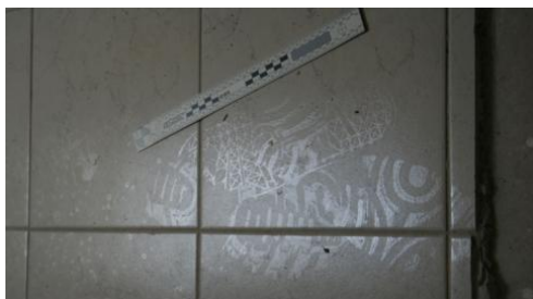
Obr. 4 Navrstvená stopa zviditelněná pomocí šikmého osvětlení
